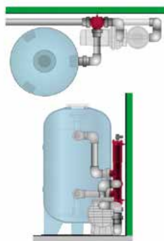
MONTAJE EN LA PARED
